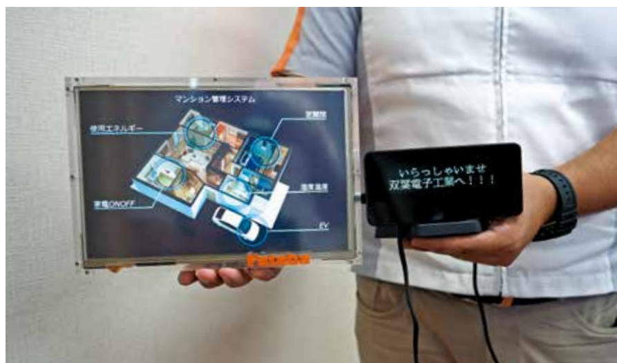
図1: 双葉電子が開発した液晶モジュール (デモ機) (左) とVFDモジュール (右) の外観。
